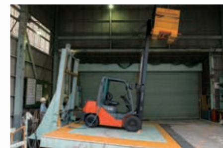
Prueba de Inclinación
